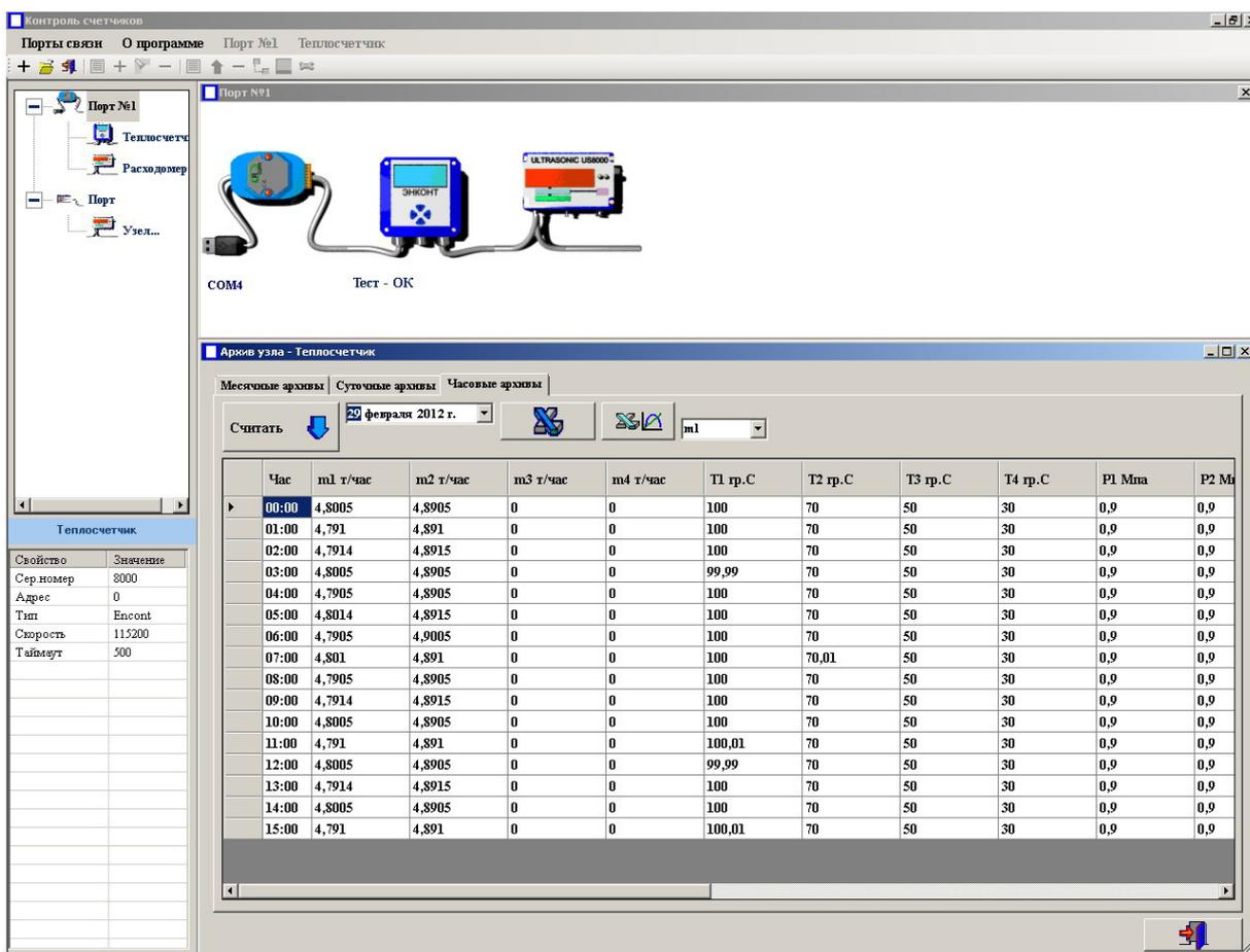
Приборы могут подсоединяться к COM-портам компьютера (реальным и виртуальным), образуя подсети. Таки образом, порт в программе означает физическое устройство в компьютере, обеспечивающее интерфейс с периферией. В нашем случае он используется для обмена данными с приборами учета. Программное обеспечение работает непосредственно с последовательными портами (COM1, COM2 и т.д.), которые могут быть как реальными, так и виртуальными.
